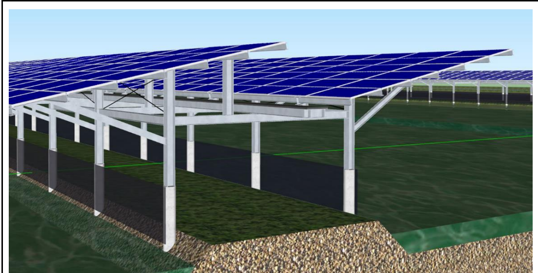
圖 4-8 太陽能設施工程（防風棚搭建）示意圖
