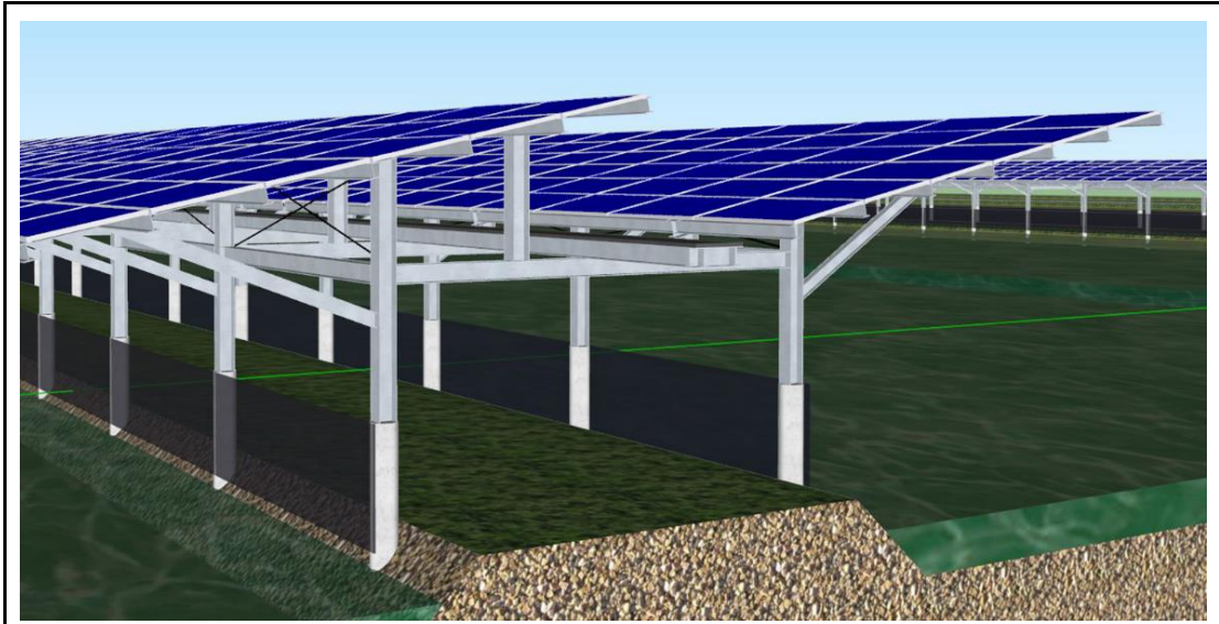
圖 4-8 太陽能設施工程（防風棚搭建）示意圖
